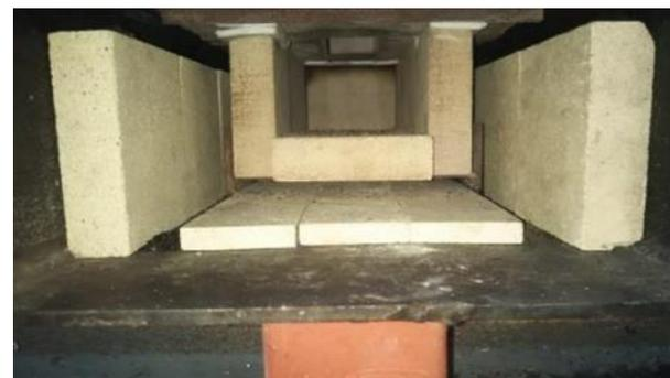
気流を折り返して滞留時間を確保 耐火レンガによって蓄熱性が上がり、燃焼室全体の温度が高温で安定
