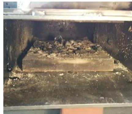
バーナー口から吹出した燃焼ガスがすぐに煙管へ引き込まれ滞留時間が短く、燃焼室内の蓄熱も不十分で2次燃焼が困難
