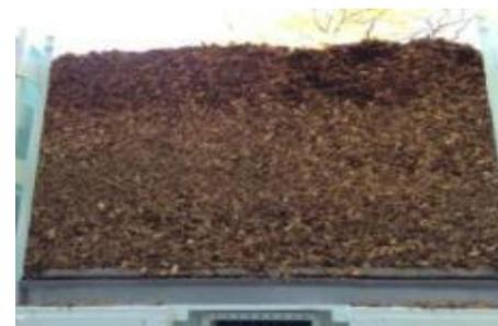
試験結果例（風量：200m<sup>3</sup>/h・チップm<sup>3</sup> 温水：24L/min）
