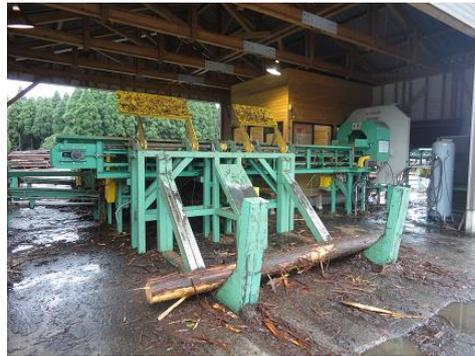
選別機による仕分け。間伐由来（発電向け）は選別する前に自動的に手前に落ちる（持ち込まれる丸太全てを選別機に通す）
